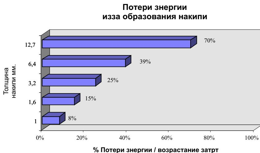
Применение аппарата Lapis-ex позволяет избежать образования накипи и, как следствие, сберечь большие количества тепла и энергии.
